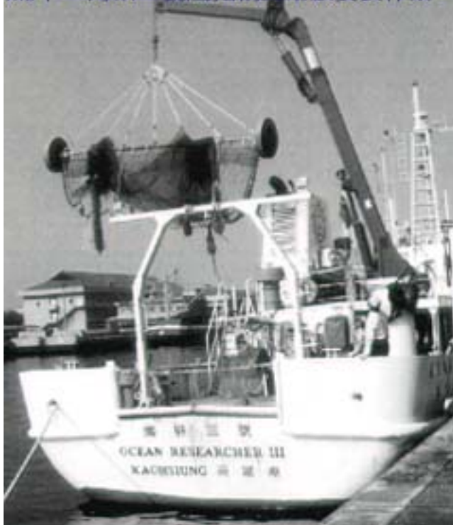
照片二：海研三號底拖網具吊放安裝作業。
