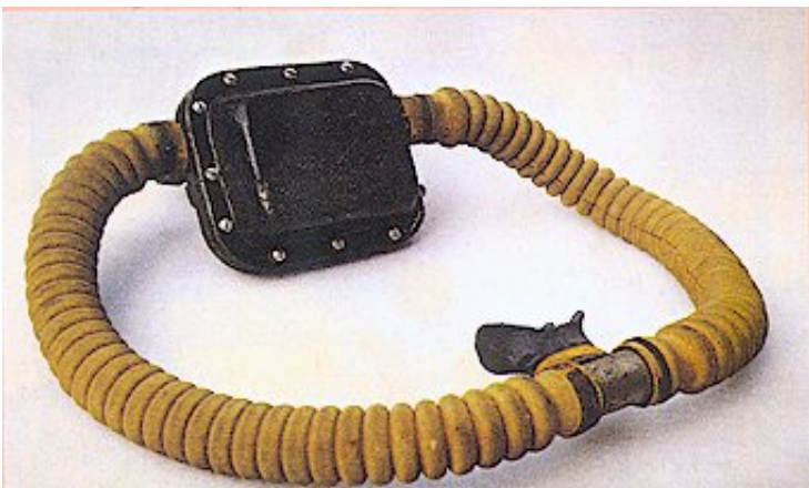
■ 1943年，法國的顧士都與工程師卡里安全作，製造出開放式水肺潛水裝備，使潛水活動開始脫離軍事的影子，成為普遍而成熟的戶外休閒運動，圖為最早製作出的高壓潛水調節器。
