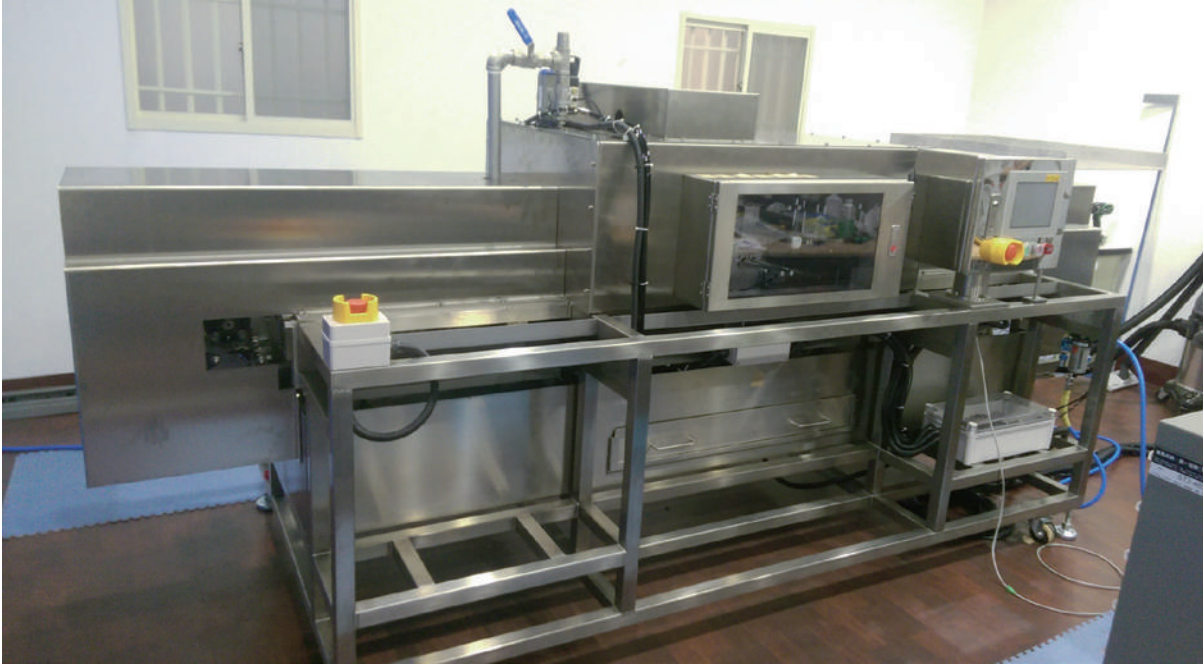
製作完成的石斑魚去鱗機商品機，目前以非專屬授權技轉盛洋冷凍食品股份有限公司。
