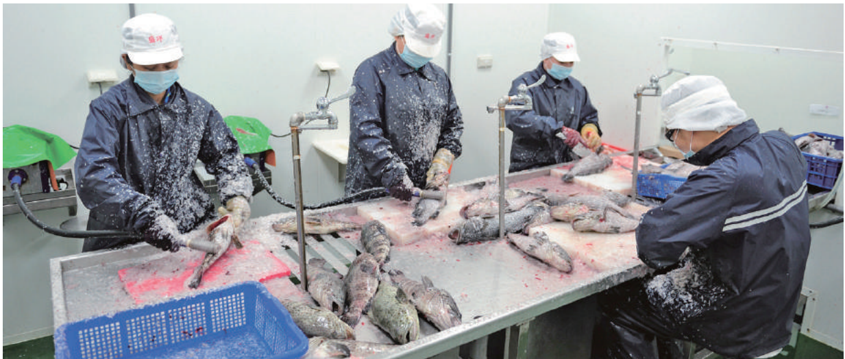
石斑魚生產線所使用的去鱗、除鰓去內臟工作檯之作業狀況。（102年攝於盛洋冷凍食品股份有限公司）
