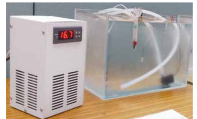
圖 4 1 呎缸冷水試驗，缸壁已結霧。
