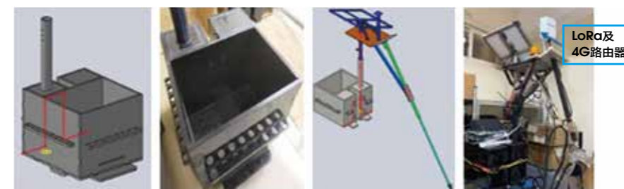
海上箱網養殖輕量型載具設備，可容納聲納、攝影及無線通訊系統
