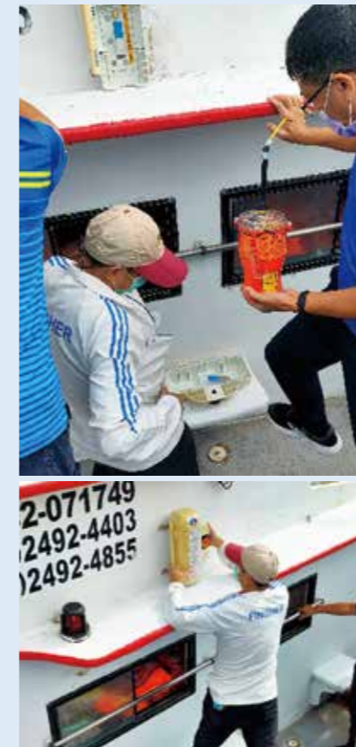
上 | 娛樂漁業漁船之船舶應急指位無線電示標（EPIRB）測試 下 | 娛樂漁業漁船通訊設備檢查
