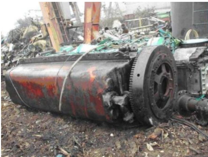
主機引擎曲軸切斷後
