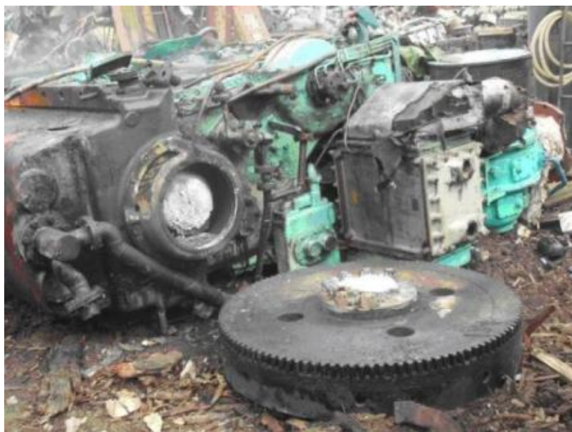
主機引擎曲軸切斷後
