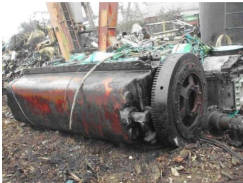
主機引擎曲軸切斷後
