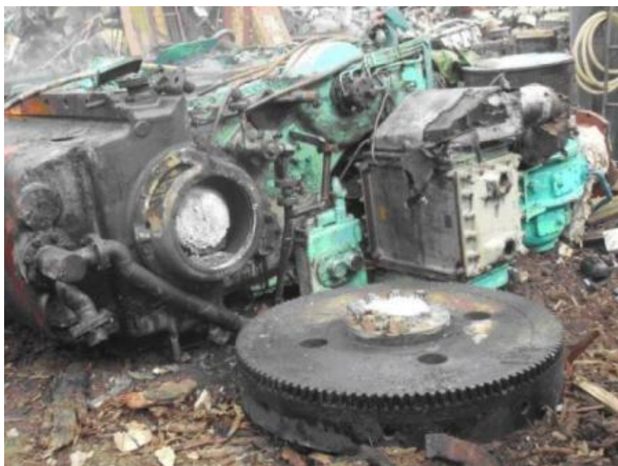
主機引擎曲軸切斷後
