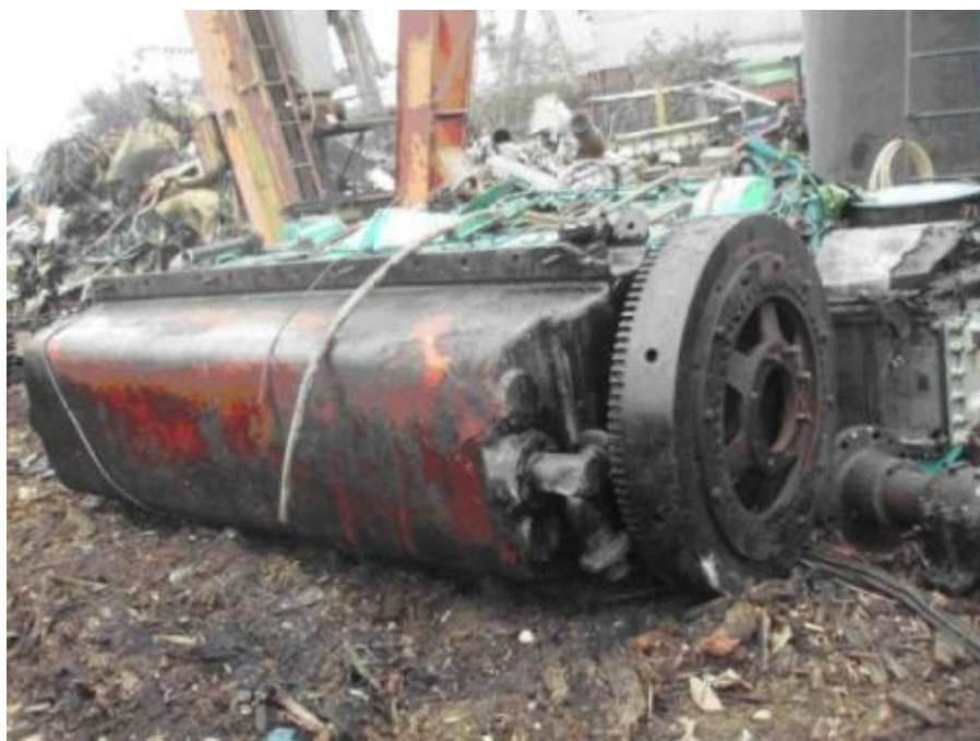
主機引擎曲軸切斷後
