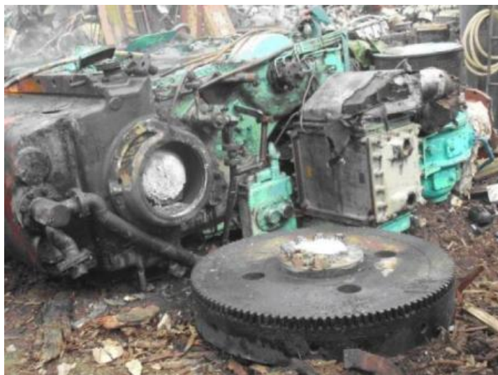
主機引擎曲軸切斷後
