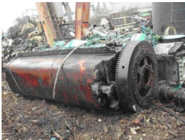
主機引擎曲軸切斷後
