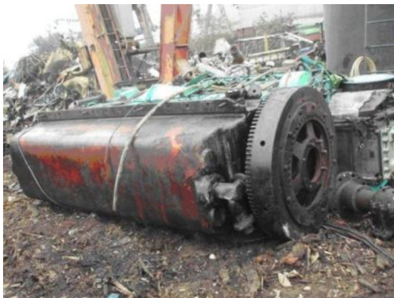
主機引擎曲軸切斷後
