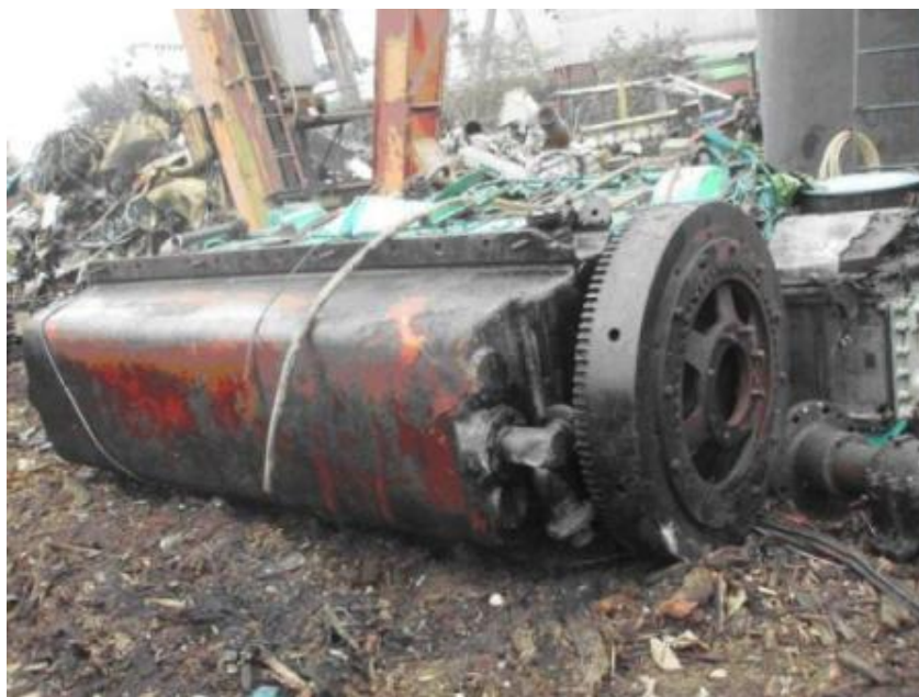
主機引擎曲軸切斷後
