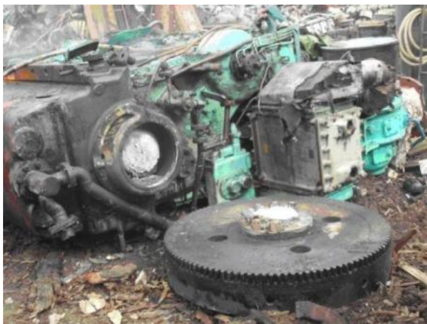
主機引擎曲軸切斷後
