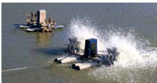
▲ 直流（DC）變頻直驅馬達水車使用情形。
