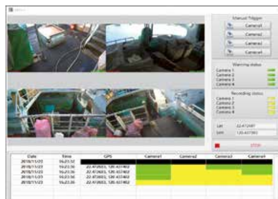
▲ 電子觀察員系統介面（左上方為錄影狀態、右上方為各錄影鏡頭運作狀態、下方為事件紀錄簿）。
