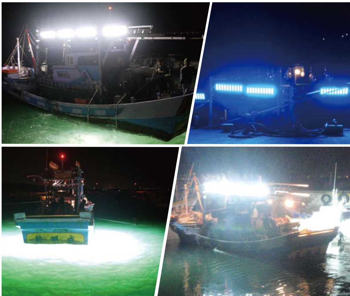
圖3／水上型與水下型高亮度LED集魚燈具之使用情況。
