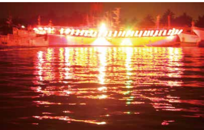
A區為傳統燈具組成，耗電量約360kW。
