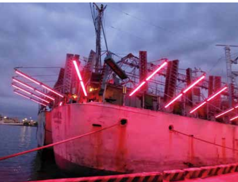
LED集魚燈之體積與重量均較傳統燈具較輕。
