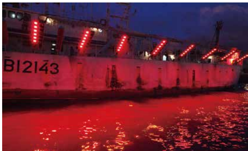
B區為LED燈具組成，耗電量約9kW。
