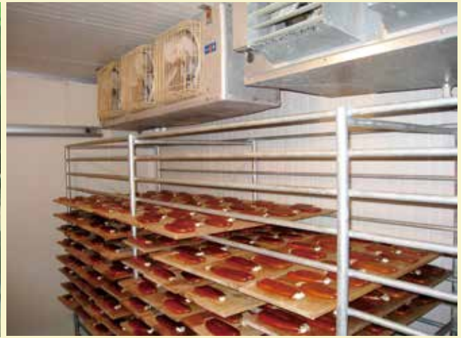
機械式冷風乾燥烏魚子。
