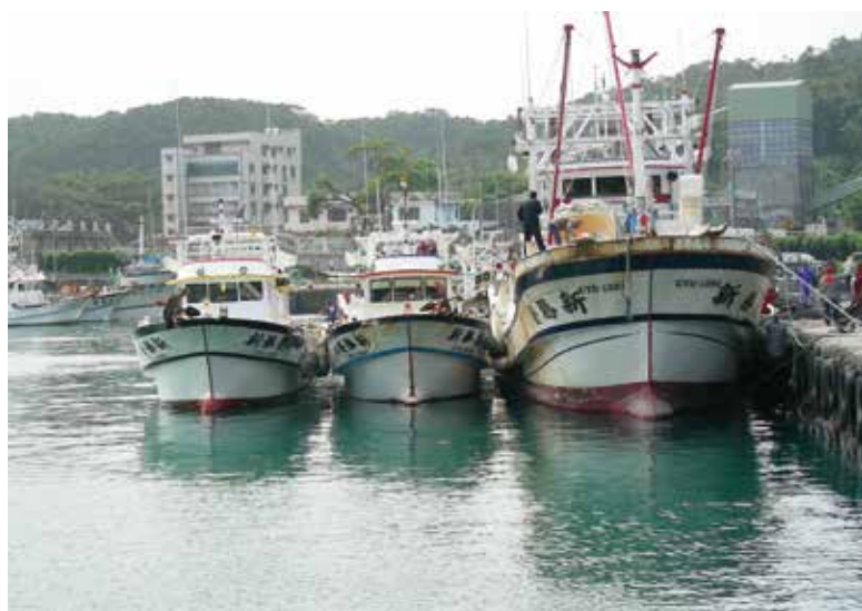
（圖四）新北市澳底地區的大型船團式扒網船，右側為網船、中及左側為燈船。
