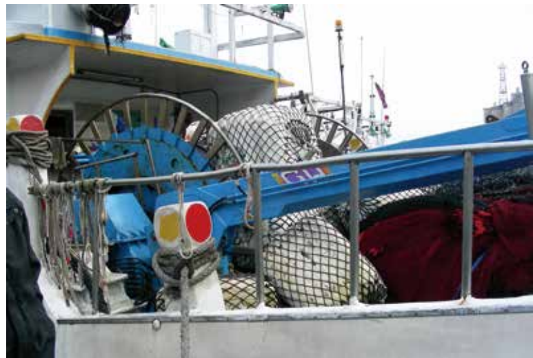
(圖六) 船團式扒網浮子網上的浮子已改用大型浮具代替。
