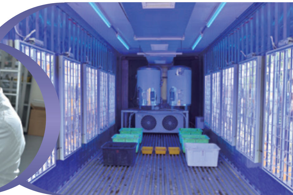
「綠能乾燥系統」運用 LED 燈、紫外線燈，可以讓環境生菌數下降，除了節能還能確保衛生品質。
