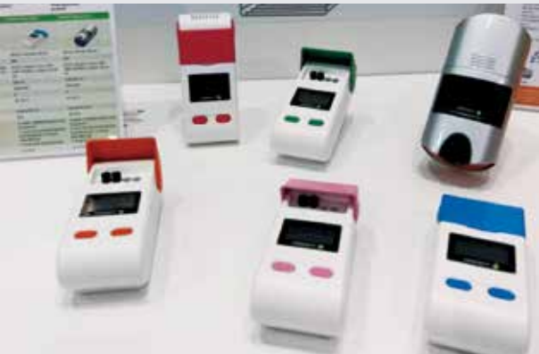
由瑞基海洋生物科技（股）公司所產的隔絕式恆溫聚合酶鏈鎖反應器（iiPCR），一次可鑑定4個樣本，反應時間30分鐘，可使用鋰電池或是110V的交流電。
