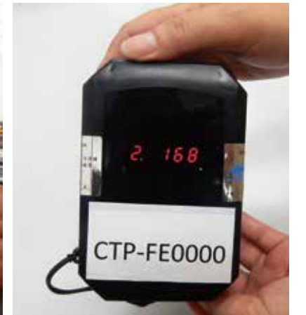
攜帶式VDR外殼由防水、防塵、抗UV材質所製，充電完畢後可連續使用7天以上。
