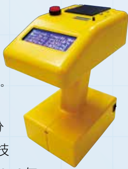
海洋弧菌自動化檢測系統。
