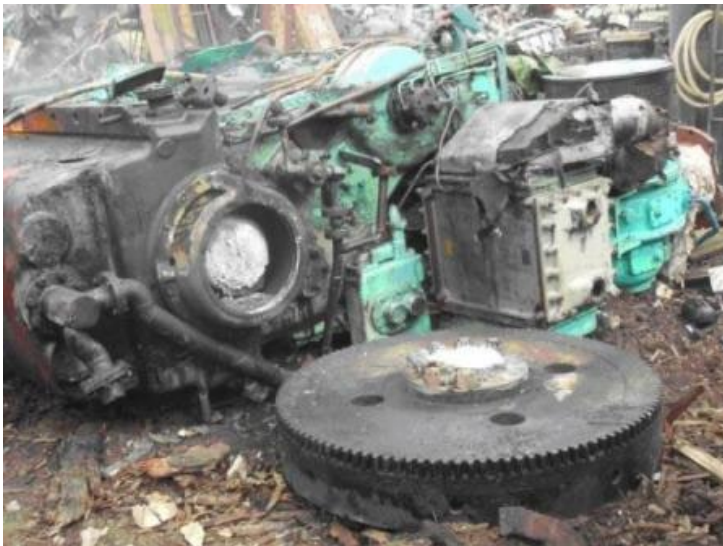
主機引擎曲軸切斷後
