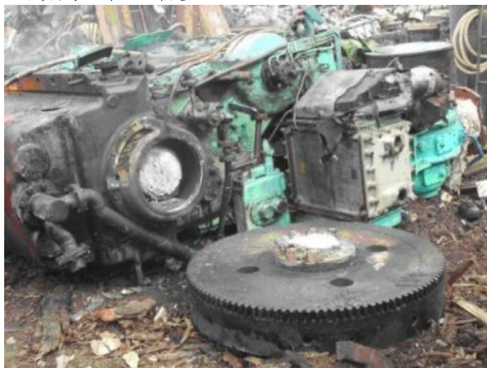
主機引擎曲軸切斷後
