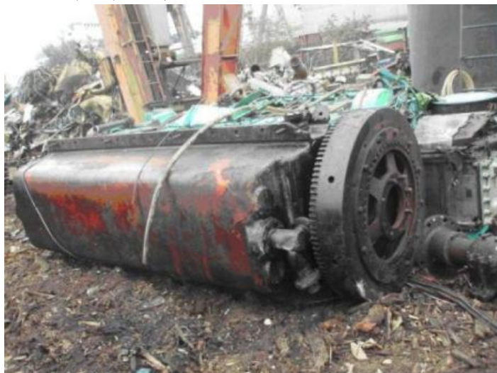
主機引擎曲軸切斷前
