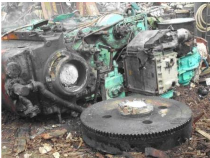
主機引擎曲軸切斷後
