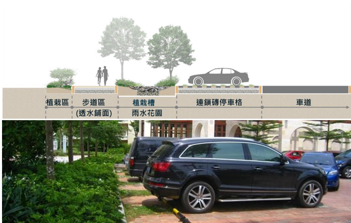
圖 2.4- 4 停車場美化建置剖面示意圖
