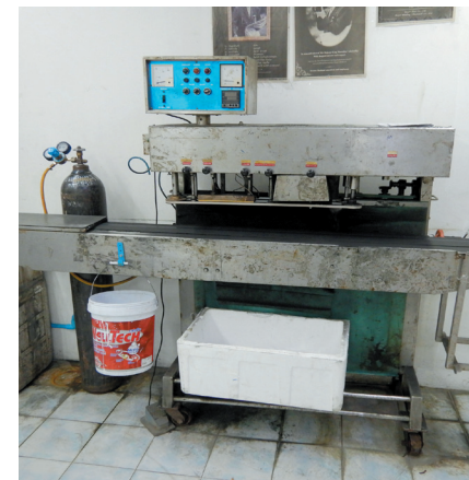
泰國魚場用以包裝泰國鬥魚的包裝機器，自動化的注水、包裝與封口，有助於降低生物在包裝過程的時間延遲與衍生不適。
